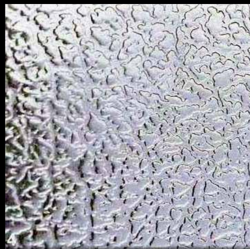
Leicht abgewischter Fingerabdruck auf der behandelten Oberfläche • schnelle und einfache Reinigung • saubere und homogene Oberfläche
