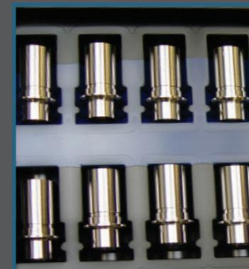
Das Elektropolieren baut den Werkstoff ohne mechanische, thermische und chemische Belastung ab. Geschädigte Werkstoffschichten werden durch das Elektropolieren beseitigt.
